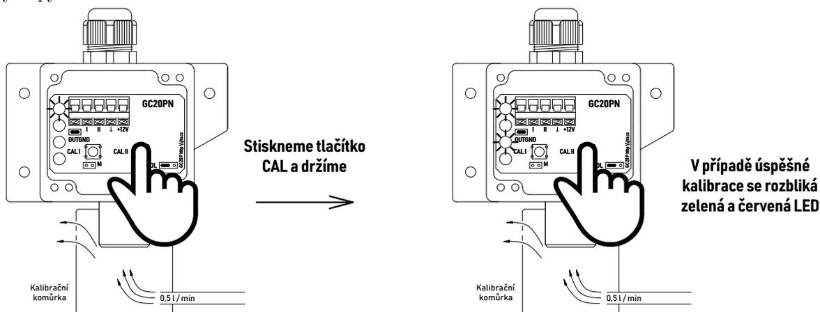
Zmáčknete tlačítko CAL a držte jej. Červená LED se rozbliká rychleji, po desíti sekundách začne nepřetržitě svítit. Stále mějte přiveden kalibrační plyn a držte stisknuté tlačítko až do doby, než se červená LED opět rozbliká
