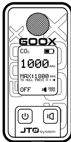
Detektor GOOX je přístroj určený k monitorování koncentrace oxidu uhličitého (CO<sub>2</sub>) v ovzduší. Jeho hlavními přednostmi jsou snadná obsluha, jednoduché použití, malé rozměry a dobrá mechanická odolnost. **Přístroj umožňuje nastavit úroveň koncentrace, jejíž překročení je indikováno pomocí nepřerušovaného pís-kání.**
