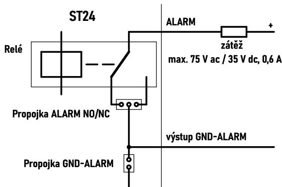
Při zapojení do proudové smyčky se výstup ALARM nepoužívá. Do proudové smyčky se zapojí napájení snímače. Odběr snímače je následující:
