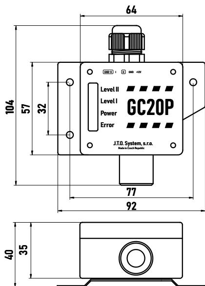
Úkolem detektoru je včasné vyslání signálu o vznikající potenciálně výbušné atmosféře. Pro svou činnost používá neselektivní žhavené polovodičové čidlo, které reaguje na přítomnost široké řady hořlavých plynů nebo par. Kalibrací pomocí požadované konkrétní hledané látky se dosahuje přesného nastavení pro jednotlivé aplikace. Detektor GC20PN je možné nastavit na různé látky především uhlovodíkového charakteru jako např. vodík, metan, propan, butan, alkoholy, aceton apod.
