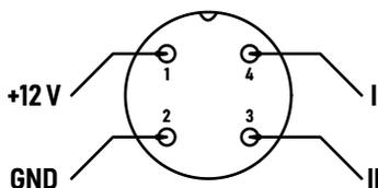
Pohled na vývody detektoru GC20PK (vývody ze strany kabelu).
