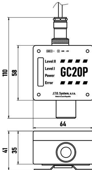
Úkolem detektoru je včasné vyslání signálu o vznikající potenciálně výbušné atmosféře. Pro svou činnost používá neselektivní žhavené polovodičové čidlo, které reaguje na přítomnost široké řady hořlavých plynů nebo par. Kalibrací pomocí požadované konkrétní hlídané látky se dosahuje přesného nastavení pro jednotlivé aplikace. Detektor GC20PK je možné nastavit na různé látky především uhlovodíkového charakteru jako např. vodík, metan, propan, butan, alkoholy, aceton apod.
