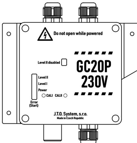
Úkolem detektoru je včasné vyslání signálu o vznikající potenciálně výbušné atmosféře. Pro svou činnost používá neselektivní žhavené polovodičové čidlo, které reaguje na přítomnost široké řady hořlavých plynů nebo par. Kalibrací pomocí požadované konkrétní hlídané látky se dosahuje přesného nastavení pro jednotlivé aplikace. Detektor GC20P-230V je možné nastavit na různé látky především uhlovodíkového charakteru jako např. vodík, metan, propan, butan, alkoholy, aceton apod.
