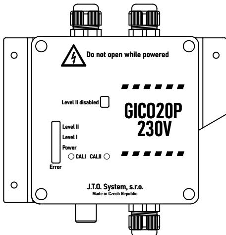
Úkolem detektoru je včasné vyslání signálu o vznikající potenciálně nebezpečné atmosféry pro zdraví. Pro svou činnost používají žhavené polovodičové čidlo, které může reagovat na přítomnost řady jiných hořlavých plynů nebo par. Speciálním postupem řízení čidla je dosaženo vysoké citlivosti na CO se sníženým vlivem jiných plynů.
